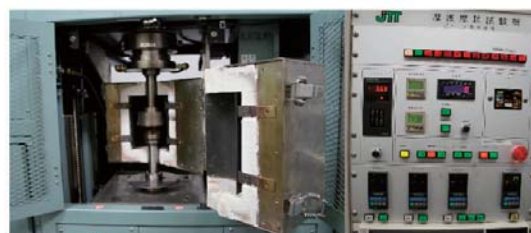
電気炉を有する高温摩耗試験機
