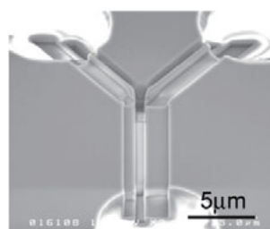
図3. FIBでガラス基板上に形成したマイクロ流路の例
