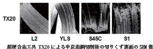
超硬合金工具 TX20 による中炭素鋼切削後の切りくず表面の SEM 像
