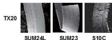
超硬合金工具 TX20 による低炭素鋼切削後の切りくず表面の SEM 像
