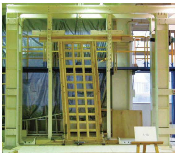
写真1 面格子壁の実験の様子
