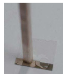
図4. ポリイミドフィルムに形成したイオンビーム直接堆積膜の剥離試験の様子
