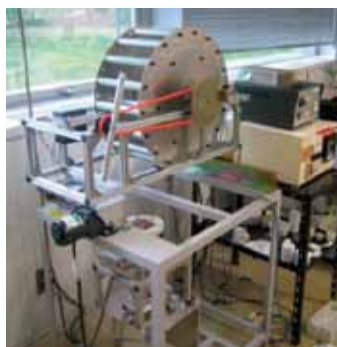
強度試験のためのガラスファイバー作製装置
