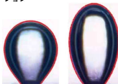
電場無し 電場有り 気泡形状に及ぼす電場の影響 (赤線は数値シミュレーションにより取得した気泡形状)
