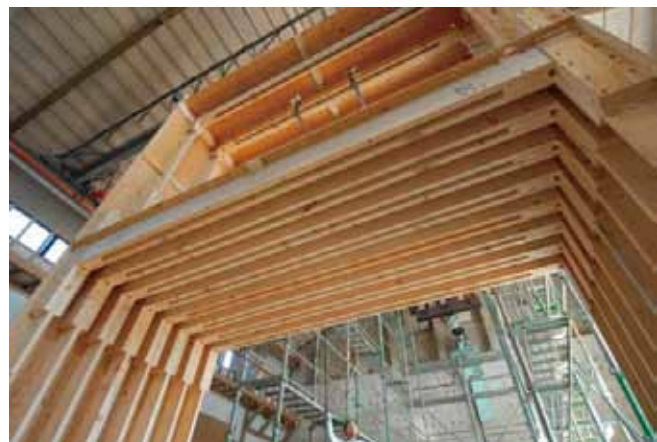
2層実大実験試験体
