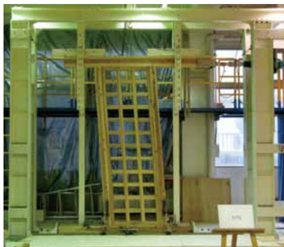
写真1 面格子壁の実験の様子
