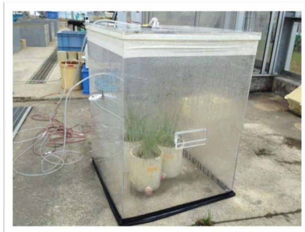
チャンバー法による温室効果ガス測定
