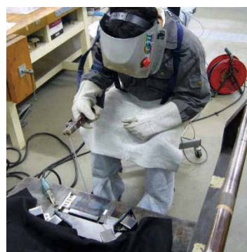
溶接作業における右腕動作と表面筋電位の測定
