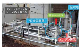
アミン水溶液を用いた排気CO 2 の選択分離回収装置
