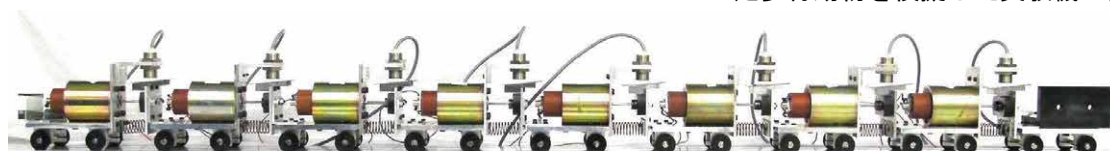
摩擦の大きい路面における8自由度のばね・質点系とみなせる連結台車のモード形成
