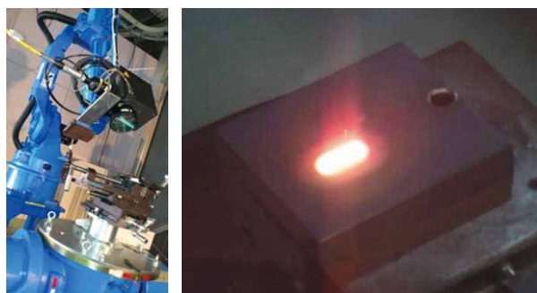
レーザ熱処理によるセラミックス被覆鋼の高機能化
