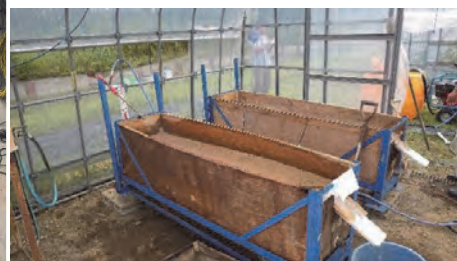
図3 石灰系改良土の表面流出試験
