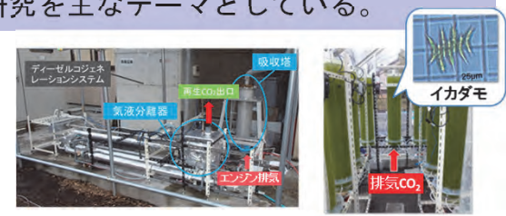
アミン水溶液を用いた排気CO 2 の選択分離回収装置
