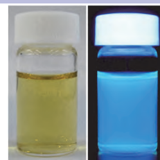
C-dotsの良好な水分散性(左)とUV照射下での蛍光特性(右)
