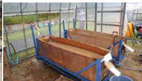
図3 石灰系改良土の表面流出試験
