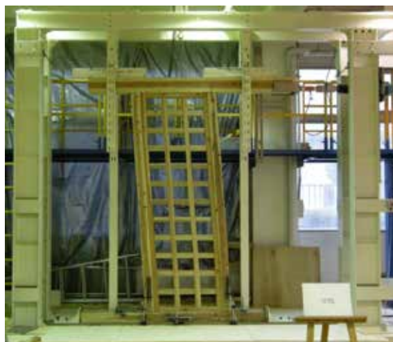
写真1 面格子壁の実験の様子
