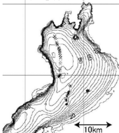
図2 湖底地形図と2012年1月時点でのベントの位置（X印）。等深度線は5m間隔で書かれている。数字の単位はm。（提供：熊谷道夫（元・滋賀県琵琶湖研究所））
